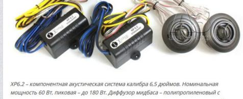
XP6.2 - компонентная акустическая система калибра 6.5 дюймов. Номинальная мощность 60 Вт, пиковая - до 180 Вт. Диффузор мидбаса - полипропиленовый с наполнителем из слюды, купольный твиттер XT20 диаметром 20 мм - поворотный. Кроссовер твиттера с частотой среза 5.5 кГц, мидбас работает в ползатной полосе частот. Благодаря компактной конструкции установка этой системы не создаст проблем
