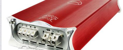
Четырехканальный усилитель MAGMA 220.4AB развивает в каждом канале мощность 220 Вт на нагрузке 4 Ом и 300 Вт на нагрузке 2 Ом, коэффициент гармоник 0,01%. Длина корпуса 460 мм.
